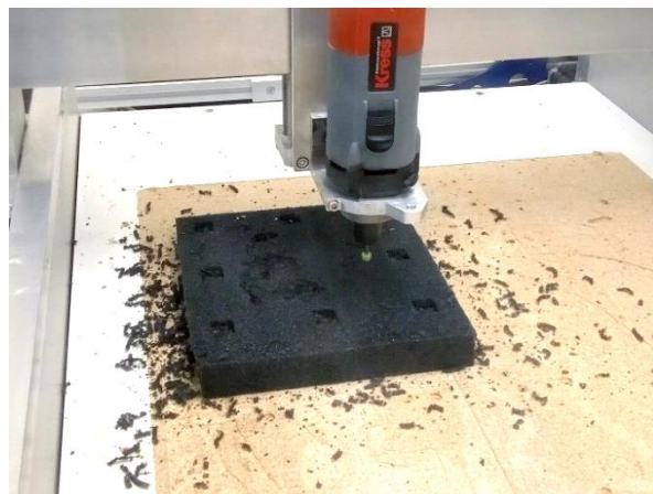
Figure 31 Finition d'un support avec une fraise de 1 mm de diamètre
