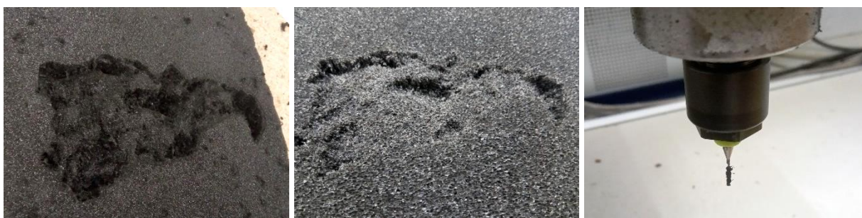
Figure 17 Résultat du test d'usinage de la Plastazote®
