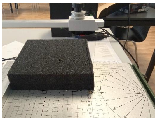
Figure 39 Découpage au fil chaud
