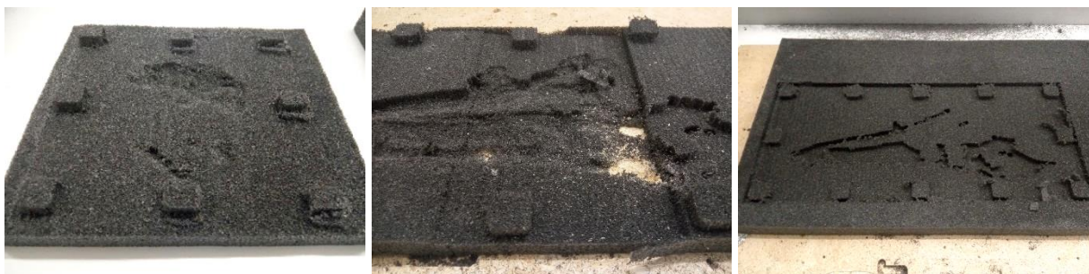
Figure 32 Support pour la face B de GRC-160 avec erreur d'usinage Figure 33 Support détruit après dysfonctionnement de la CNC Figure 34 Support non terminé suite à l'arrêt de la machine
