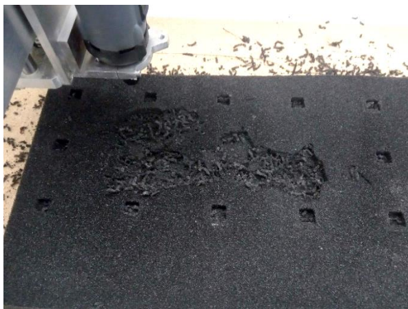
Figure 30 Ébauche d'un support avec une fraise de 3 mm de diamètre
